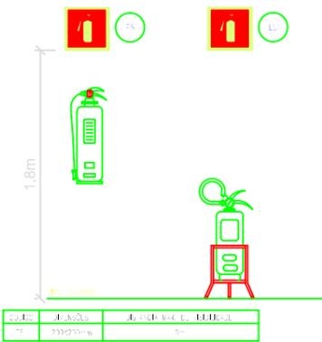
DETALHE TÍPICO SINALIZAÇÃO DE EXTINTORES EM PAREDE
