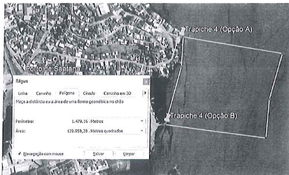
Figura 13 – Área do levantamento batimétrico multifeixe e monofeixe.
